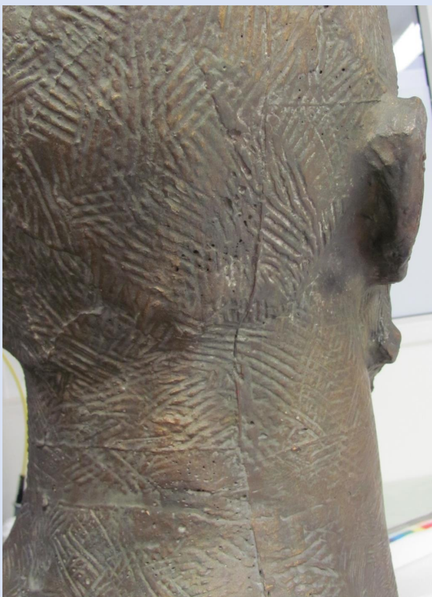
Spáry viditelné na odlitku ze skládané vícedílné formy
