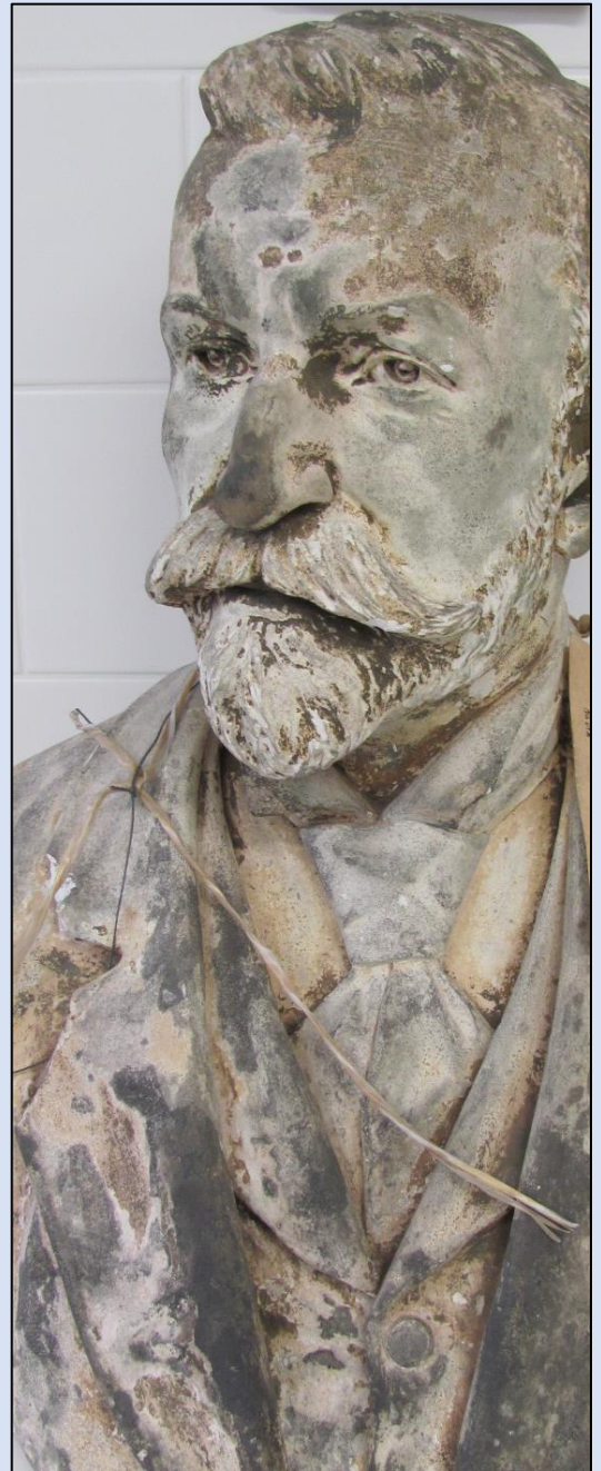
Produkty koroze kovových konstrukcí působením vlhkosti prostupují na povrch sádky
