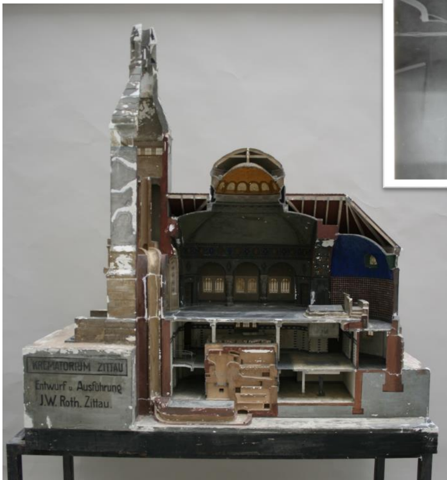
Model Krematoria v Žitavě, J. W. Roth, 1911, Národní technické muzeum, polychromovaná sádra, měřítko 1:25; plastika plná železných konstrukčních výztuží
