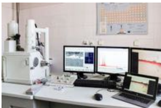
Obr. 48 – Skenovací elektronový mikroskop JEOL JSM-6460 LA s energiově-disperzním rentgenovým detektorem a vzorkovací komorou.
