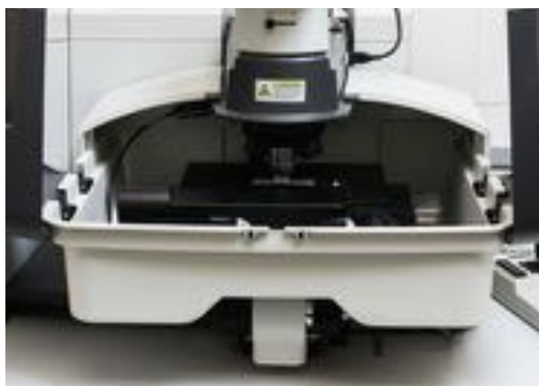
Obr. 52 – Ramanův mikrospektrometr v chemicko-technologické laboratoři Národní galerie v Praze. Vnitřní vzorkovací prostor.
