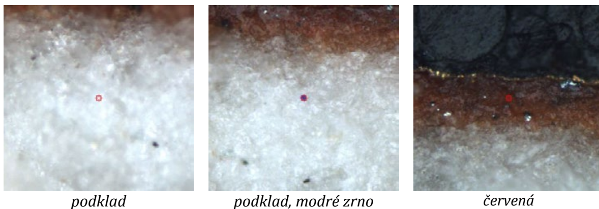
Obr. 14: Snímky z Ramanova mikroskopu s vyznačením měřených bodů ve spodní vrstvě podkladu (bílá) a vrstvě pod pokovením (červená)
