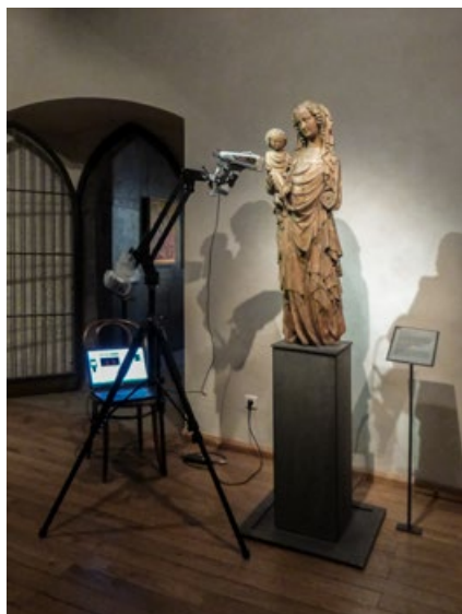
Obr. 38 – Mobilní XRF je fixován na stojanu, měření je prováděno bezkontaktně, řízeno přes PC přímo ve výstavních prostorách Národní galerie v Praze.
