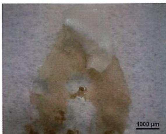
Obr. 5: Tenké řezy vzorku dřeva s parafínem
