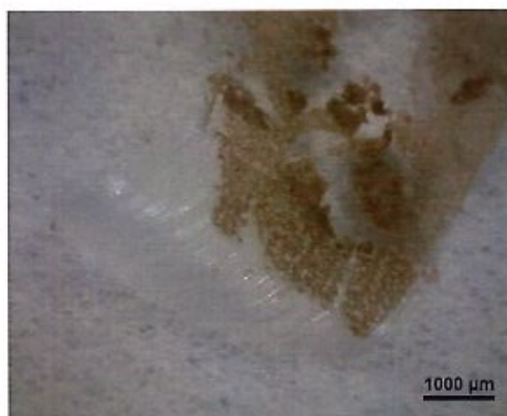
Obr. 5: Tenké řezy vzorku dřeva s parafínem
