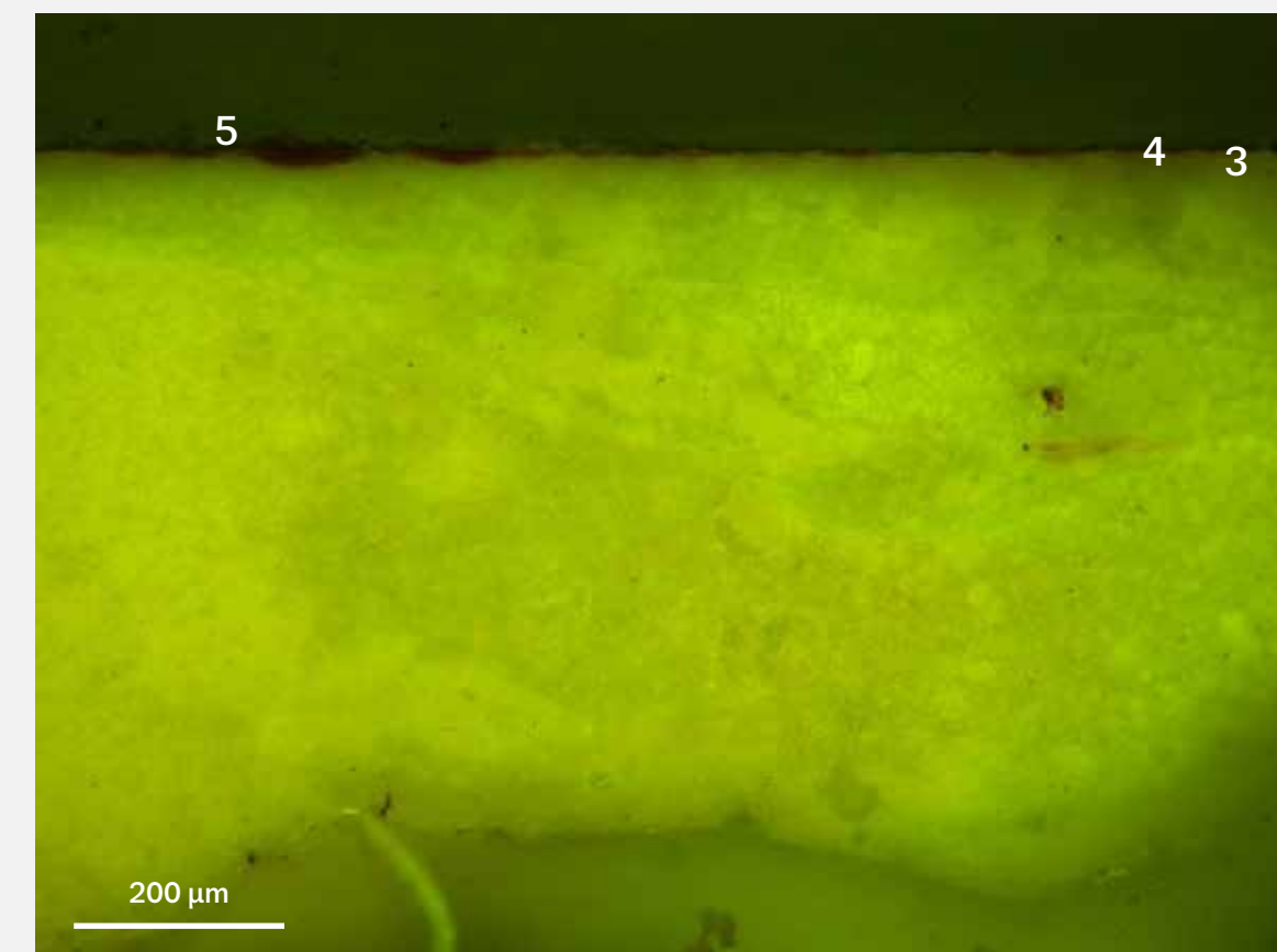
Mikrosnímek vzorku polychromie v ultrafialovém světle s filtrem \lambda = 450\text{--}490\text{ nm} .
