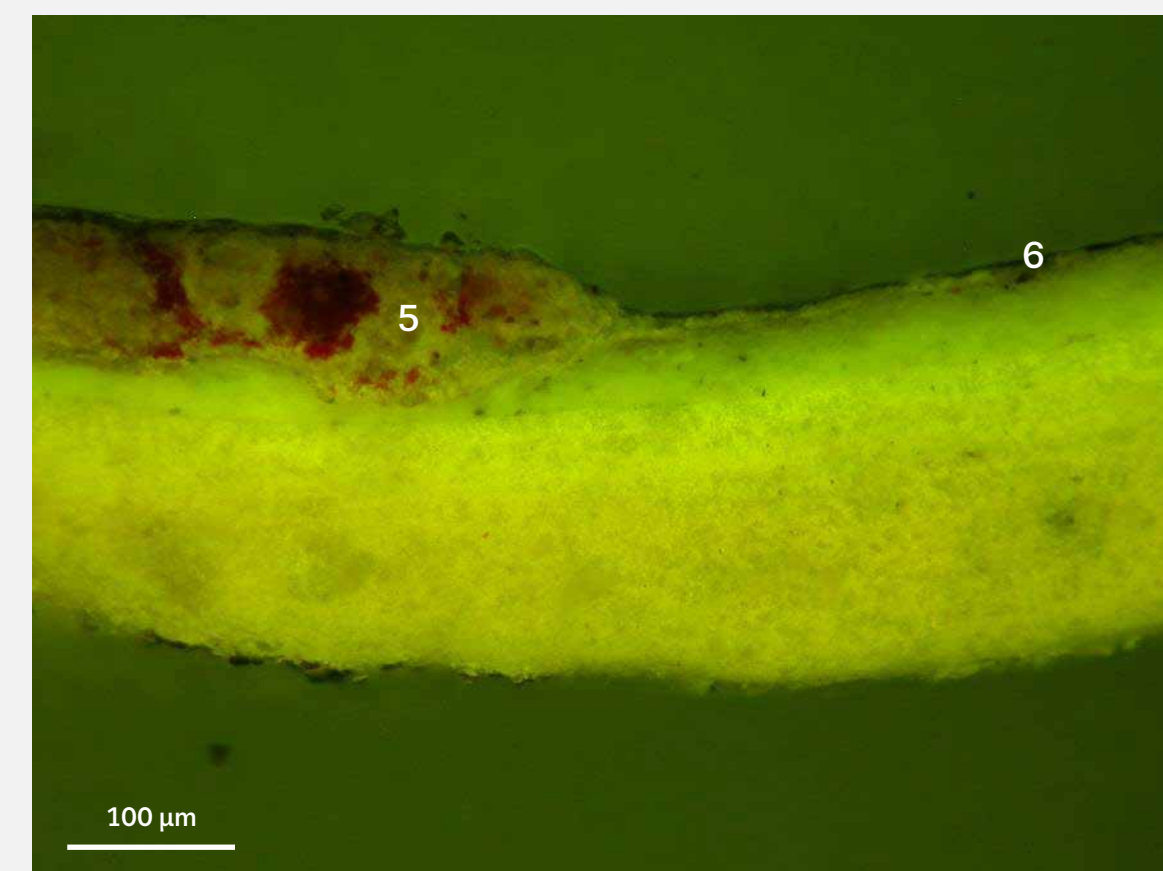
Mikrosnímek vzorku polychromie v ultrafialovém světle s filtrem \lambda = 450-490 nm.
