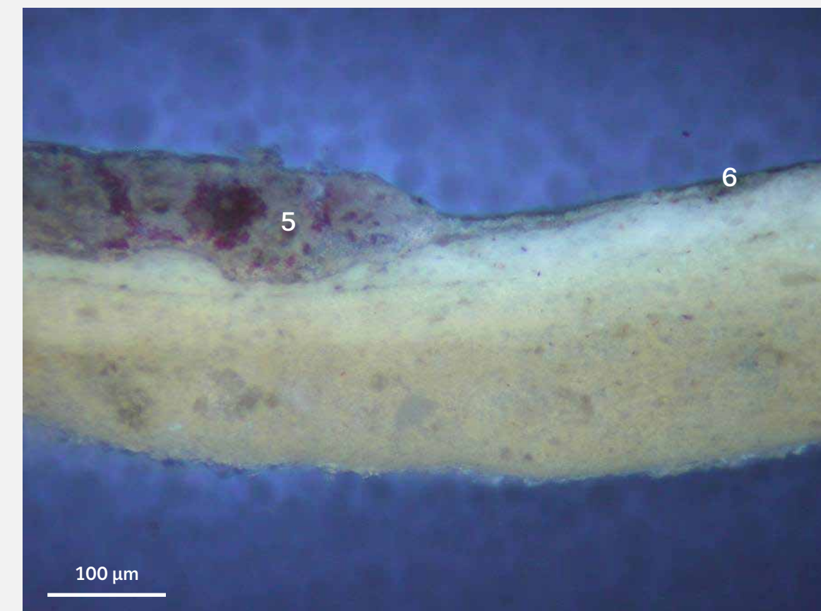
Mikrosnímek vzorku polychromie v ultrafialovém světle s filtrem \lambda = 330-380 nm.
