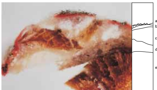
Abb. 6 Probe Nr. 5 – Fassungsfragment, Löwenmähne (von der Seite über dem Ohr des Löwen) a Goldfarbene Ölfarbschicht – Gemisch aus Kupfer und Zink; Bronze 0,018 mm b Rote Ölfarbschicht – Eisenrot, Ocker 0,027 mm c Leimschicht mit gefällter Kreide, in die beschädigte Holzoberfläche eingelaufen 0,229 mm d Graue Schicht, eiweißgebunden – Kalksulfat 0,102 mm e Leimgetränktes Holz – als Eiche ( Quercus ) identifiziert
